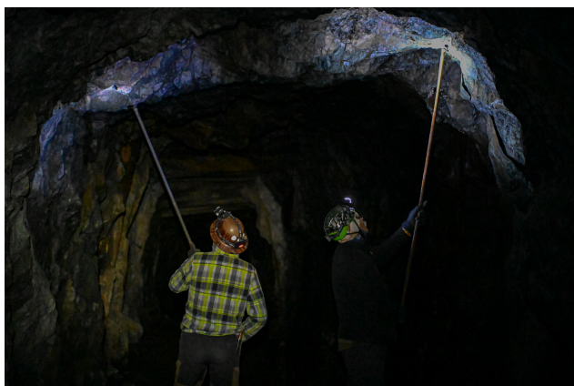
Skrotning i Bastnäs nya stolle
